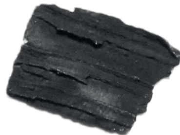
Mögliche Schadensursache: Bruchstücke des Katalysators
